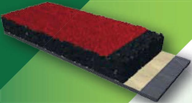
**Sprey Sistem Atletizm Pisti:** Alde Spray IST yüksek maliyetli bir palet sistemi sunar. Aşınma yüzeyi, seçilen küçük boyutlu EPDM kauçuk granülleri ile önceden karıştırılmış yapışal bir sprey kaplama bilesigidir. Özel bir asfaltlama makinesi tarafından uygulanacak, poliüretan bağlayıcı ile karıştırılmış, yerinde yapılan BSR granüllerinin taban katmanına kurulacaktır. Bu sistem kurumsal ve istirahat alanı için ekonomik bir çözüm sunar.
